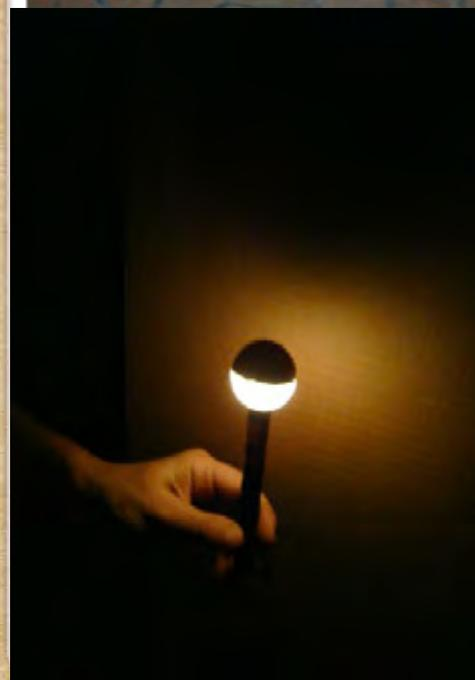
**Prueba de faroles con apantallamiento, especiales para control de la contaminación lumínica**
