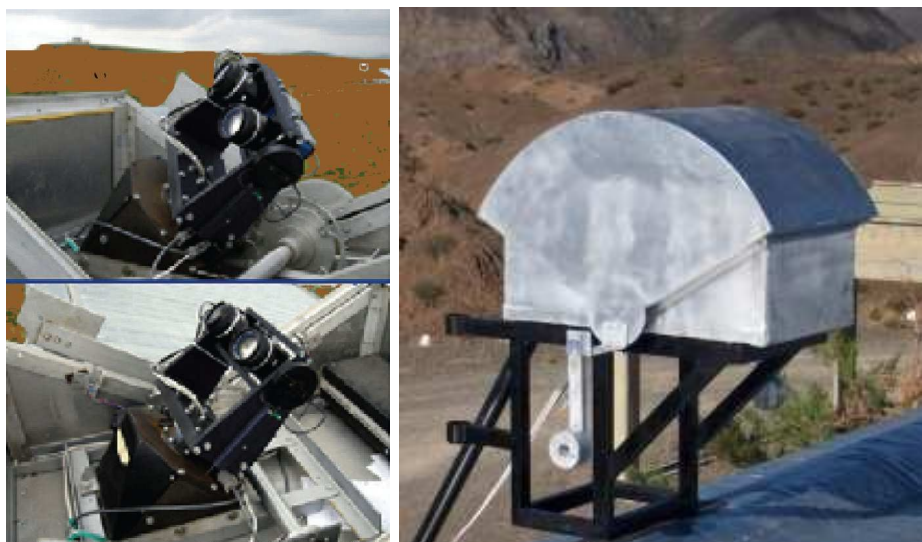
Figura 1. Disposición de las cámaras MASTER-ICATE. Panel izquierdo: las dos cámaras VWF ubicadas sobre la montura. Panel derecho: imagen externa del domo cerrado y parte de la estructura de soporte.
